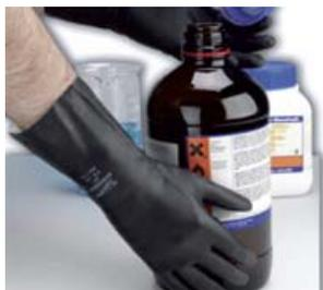
En algunos casos el guante no dará la protección esperada si no queda bien ajustado. Se producen en diferentes tallas de acuerdo con el sistema común europeo. Si un guante no tiene la longitud indicada en las tablas de tallas, el fabricante debe indicar explícitamente que se trata de un guante de una talla especial para una aplicación especial.
