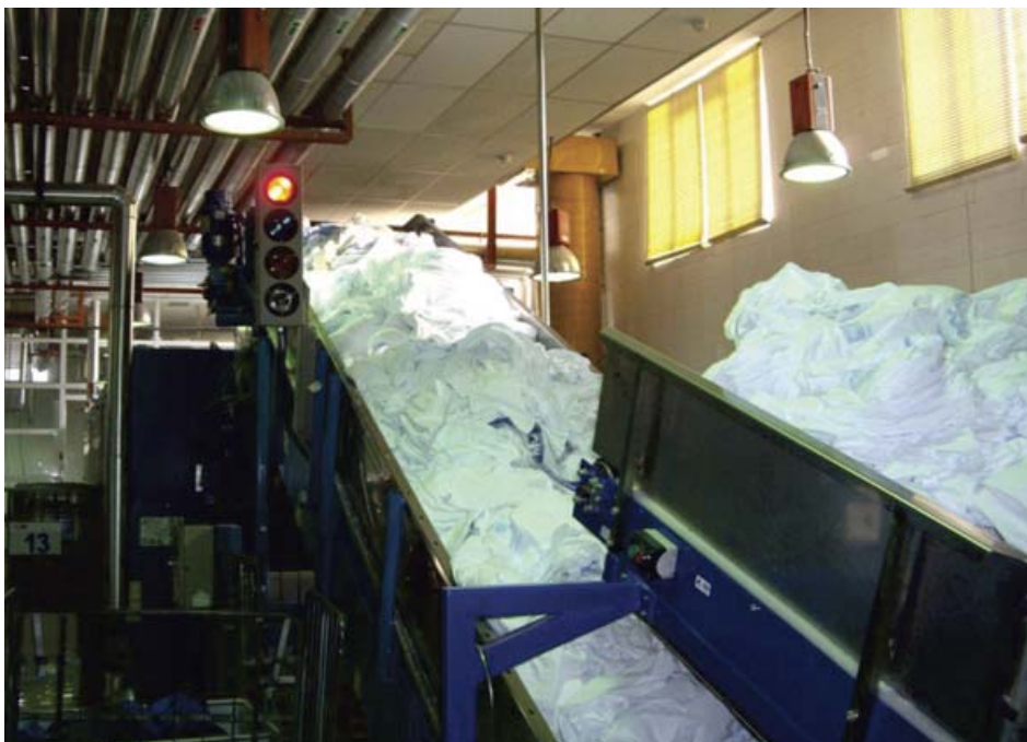
Transporte de ropa sucia por una cinta hasta la boca del túnel de lavado.
