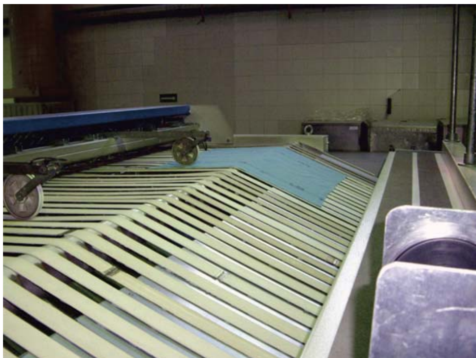
Transporte de una prenda mediante cinta de bandas en la calandra.
