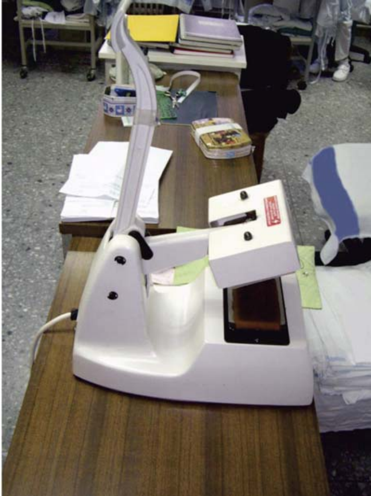
Máquina para marcar prendas mediante grabado.
