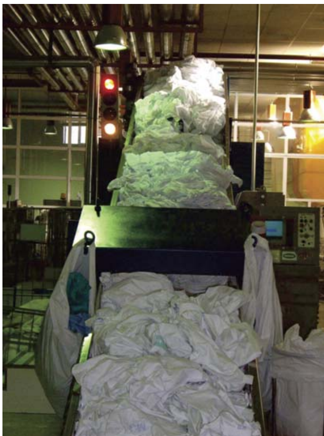
Entrada de la ropa sucia en el túnel de lavado mediante una cinta transportadora.
